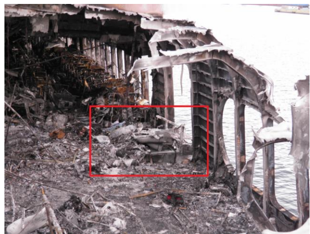
Εικόνες 3.5.1/1 & 2: Φωτογραφίες από την περιοχή στοιβασίας του Μ.Ε.Σ. κατά την πυρκαγιά (διακρίνεται το σύστημα που εκδιπλώθηκε ανεπιτυχώς και η θύρα του όπως επέπλεε μετά την πτώση της στη θάλασσα) και μετά από την κατάσβεσή της (εντός πλαισίου διακρίνονται η βάση του συστήματος και μέρος των φιαλών ενεργοποίησής του).
