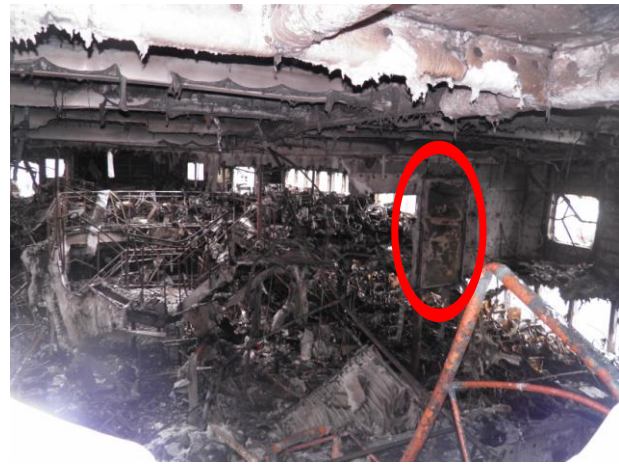
Εικόνες 4.1.1/5 & 6: Άποψη της οροφής των χώρων άνωθεν του καταστρώματος «Upper Deck» και του καταστρώματος «Bridge Deck» κοιτώντας από τη Γέφυρα Ναυσιπλοΐας προς την πρύμνη. Από τη θέση του κατώτατου τμήματος των δύο θυρών επί του Νομέα 31 που αιωρούνταν, γίνεται αντιληπτή η θέση στην οποία υπήρχε το κατάστρωμα «Bridge Deck» πριν από την πλήρη κατάρρευσή του λόγω της πυρκαγιάς.
