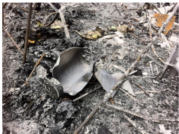
Εικόνες 3.5.1/3 & 4: Φωτογραφίες από φιάλες του Μ.Ε.Σ. που εξερράγησαν κατά την πυρκαγιά.
