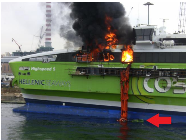
Εικόνες 3.5.1/1 & 2: Φωτογραφίες από την περιοχή στοιβασίας του Μ.Ε.Σ. κατά την πυρκαγιά (διακρίνεται το σύστημα που εκδιπλώθηκε ανεπιτυχώς και η θύρα του όπως επέπλεε μετά την πτώση της στη θάλασσα) και μετά από την κατάσβεσή της (εντός πλαισίου διακρίνονται η βάση του συστήματος και μέρος των φιαλών ενεργοποίησής του).
