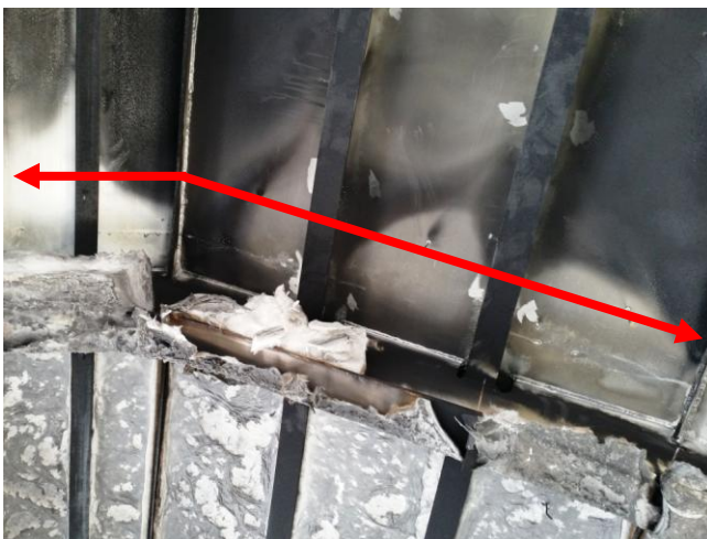
Εικόνες 4.1.3/3 & 4: Άποψη του εσωτερικού τμήματος της οροφής του σαλονιού επιβατών όπου διακρίνεται η τήξη του ελασματος σε σημεία κατά μήκος των θέσεων τοποθέτησης νέων τεμαχίων από το συνεργείο των ελασματοουργών από την εξωτερική πλευρά της οροφής και επισήμανση τέτοιων σημείων εντός κύκλων.
