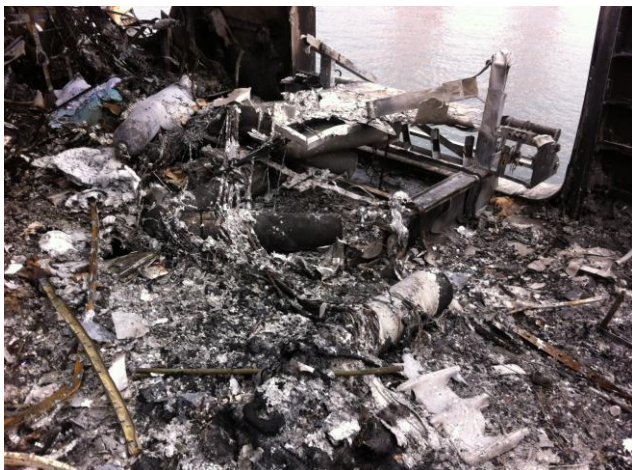
Εικόνες 3.5.1/3 & 4: Φωτογραφίες από φιάλες του Μ.Ε.Σ. που εξερράγησαν κατά την πυρκαγιά.
