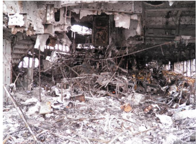
Εικόνες 4.1.1/8 & 9: Άποψη του μέσου και της αριστερής πλευράς του χώρου επιβατών «Business» άνωθεν του καταστρώματος «Upper Deck» κοιτώντας προς την πρύμνη. Διακρίνονται τα υπολείμματα του εξοπλισμού του χώρου όπου λειτουργούσε το κυλικείο μεταξύ των νομέων 20-24. Στην αριστερή πλευρά του χώρου επιβατών (δεξιά στην εικόνα αριθ. 9) διακρίνονται τα υπολείμματα των θέσεων επιβατών πρύμνηθεν του νομέα 26.
