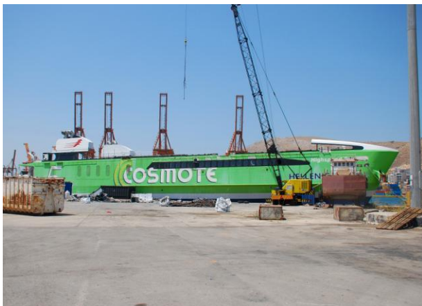
Εικόνες 3.6/5 & 6: Άποψη του πλοίου μετά την αφαίρεση της κατεστραμμένης υπερκατασκευής στο Κερασίνη και της διαδικασίας ρυμούλκησης του σε ναυπηγείο της Ιταλίας για τη διενέργεια εργασιών αποκατάστασης των ζημιών.
