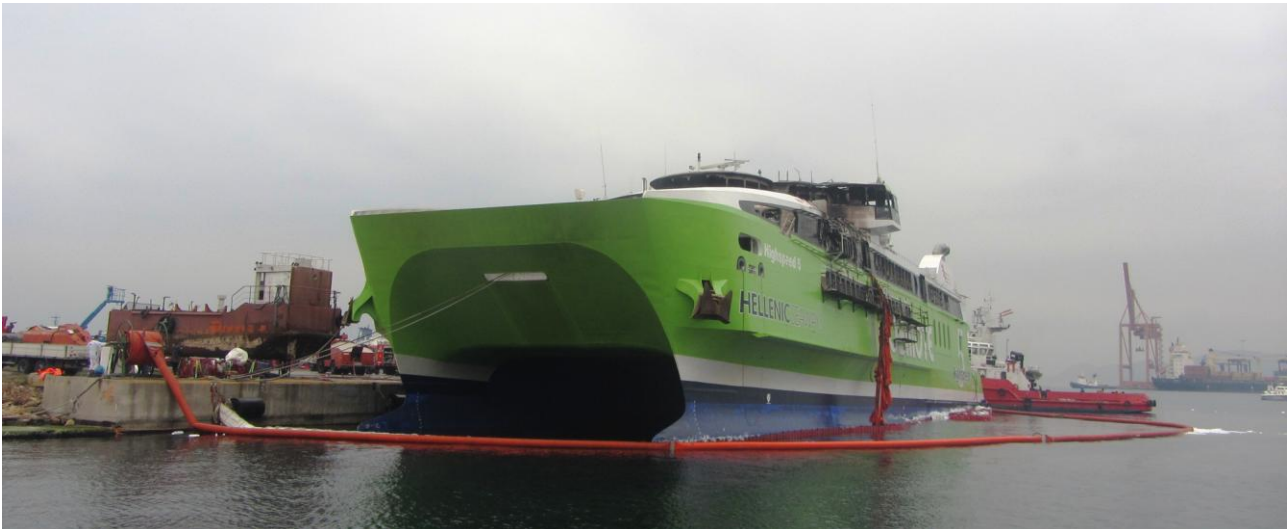
Εικόνα 3.5.3/4: Ανάπτυξη πλωτού αντιρρυπαντικού φράγματος για προληπτικούς λόγους μετά το πέρας της κατάσβεσης.
